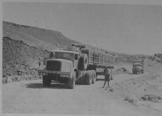
Tracteur Berliet GBO, six roues motrices, avec semi-remorque, d'une entreprise de transport mauritanienne.
